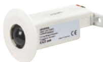
Receptor de infrarrojos, S 450 5WG1450-7AB03 Tipo: S 450/03 Recibe las señales emitidas por los emisores de mano o de pared, las amplifica y las reenvía en forma de señales eléctricas a los actuadores KNX.
